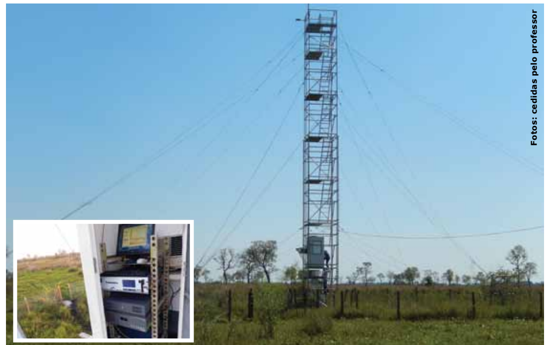
Instalado em torres na Base de Estudos do Pantanal, equipamento mede CO 2
